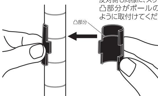
反対側も同様に、スリーブ内側の凸部分がポールの溝に合うように取付けてください。
