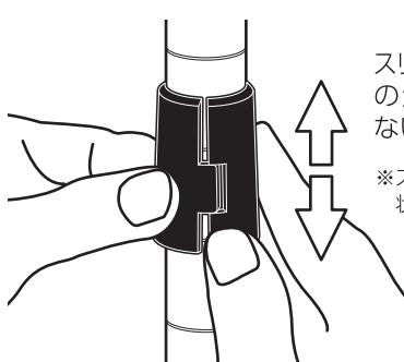
スリーブ内側の凸部分がポールの溝にはまって、上下にずれないことを確認してください。
